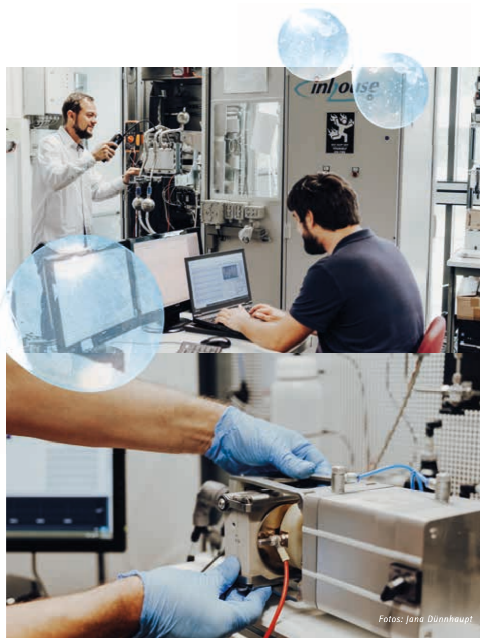
Oben: Dipl.-Ing. Michael Wenske (li.) und M.Sc. Philipp Kühne (re.), wissenschaftliche Mitarbeiter am Lehrstuhl für Elektrische Netze und Erneuerbare Energie – Abteilung Brennstoffzellen, bei der Inbetriebnahme einer stationären PEM-Brennstoffzelle.
