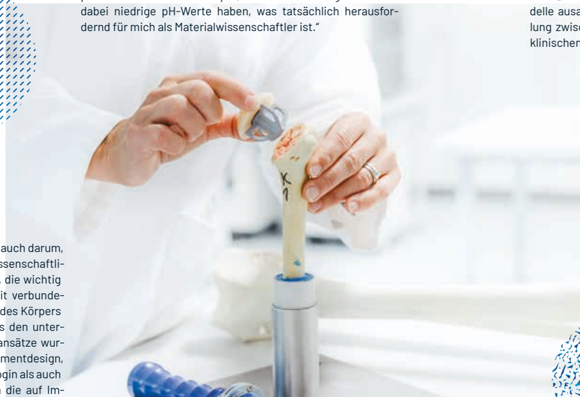
Implantation einer Schulter-Endoprothese in das Modell eines Oberarmknochens Foto: Jana Dünnhaupt
