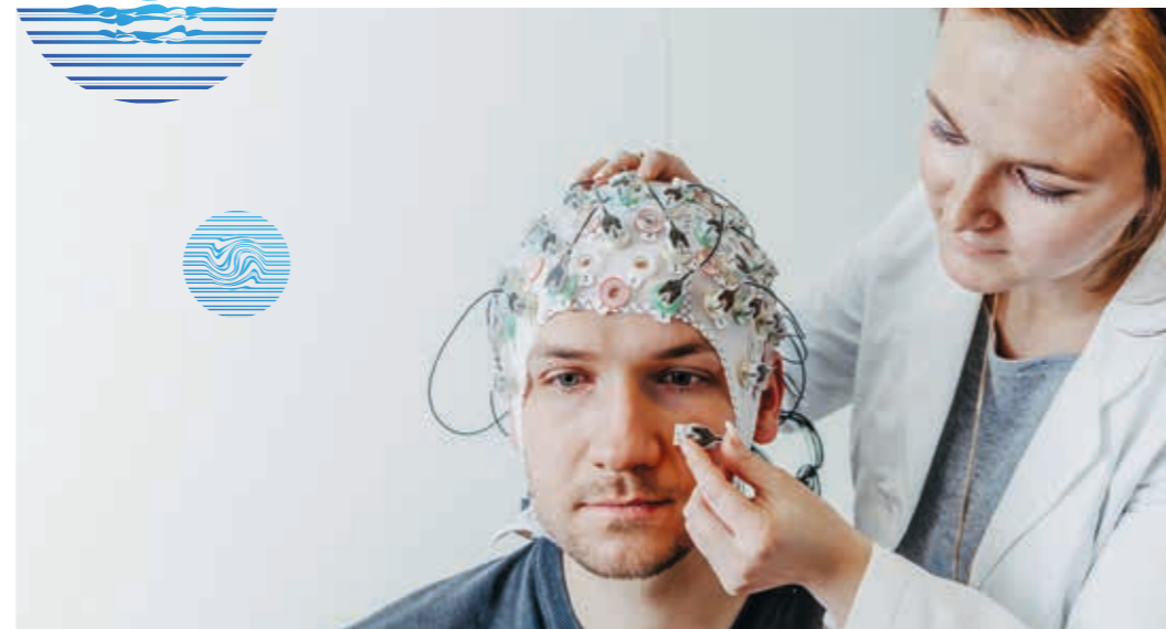
Die technische Assistentin Christina Becker legt dem Probanden eine Kappe mit Elektroden zur Messung der Hirnströme (EEG) an.
