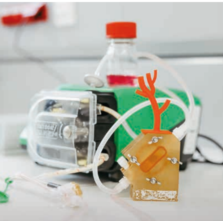
Im Bioreaktor (brauner „Behälter“) des neu entwickelten Testsystems wachsen Atemwegsmodelle heran, die bedingt in der Lage sind, Schleim zu produzieren. Kombiniert mit dem roten Modell der Atemwege wird die Ausbreitung von Aerosolen in vitro untersucht. Foto: Jana Dünnhaupt
