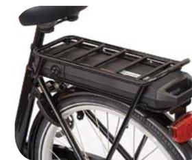
Zum abkoppeln des Akkus schließen Sie das Akkus Schloss auf indem Sie den Schlüssel rechtsum drehen. Anschließend ziehen Sie den Akku mit Hilfe des Handgriffes aus der Controllerbox.
