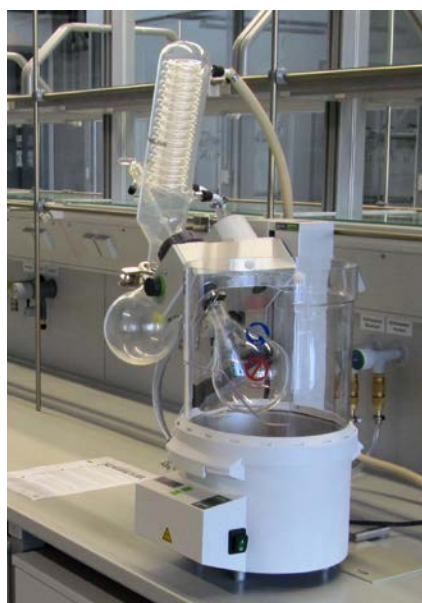
Abb. 19 Rotationsverdampfer mit beschichtetem (polycoated) Kühler und Auffangkolben
