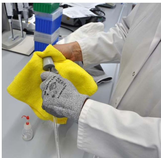
Abb. 8 Sicheres Durchführen eines Glasrohrs durch einen Stopfen
