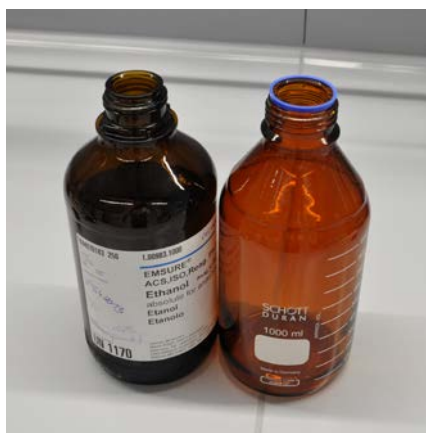
Abb. 41 Laborflaschen mit angeform- tem Gießring aus Glas (links) oder Kunststoffgießring (rechts)
