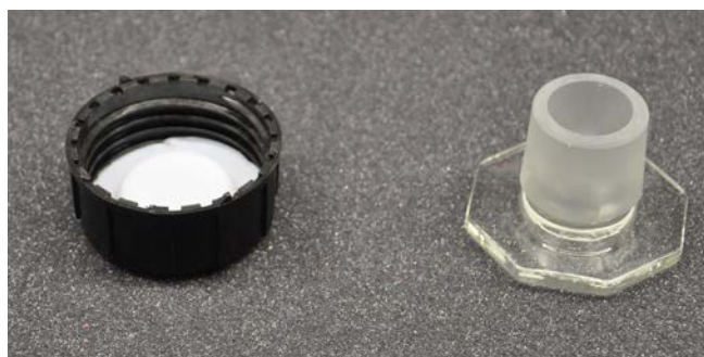
Abb. 42 Der Verschluss einer Flasche soll stets mit der Öffnung bzw. der benetzten Seite nach oben auf den Tisch abgelegt werden.
