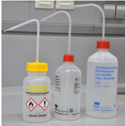
Abb. 43 Spritzflaschen für Isopropanol, Aceton bzw. destil- liertes Wasser
