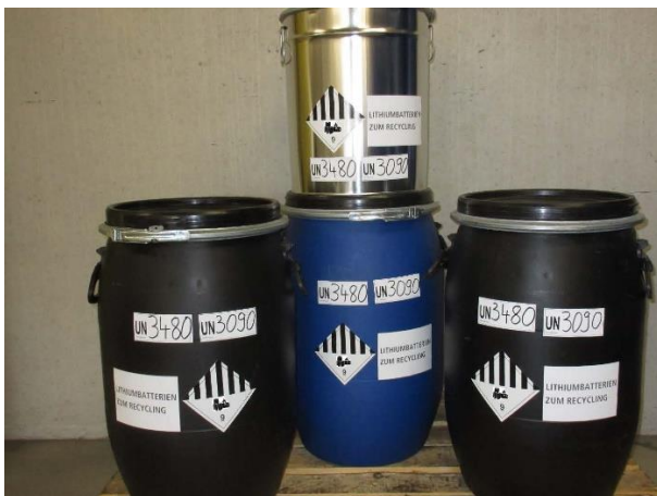
Abbildung 8: Verpackung für Batterien größer 500g unbeschädigt
