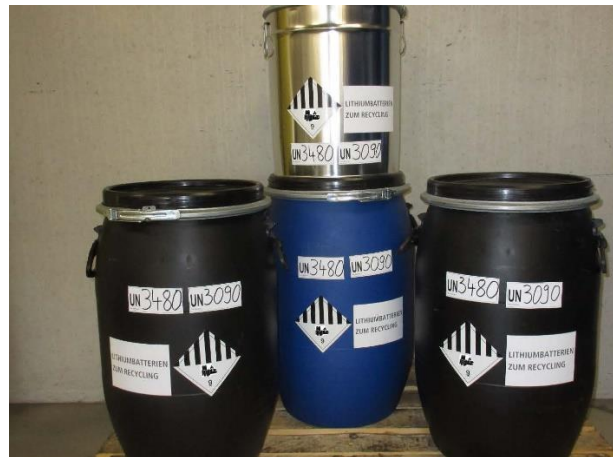
Abbildung 5: Verpackung inkl. Aufschrift und Gefahrzettel Muster 9A
