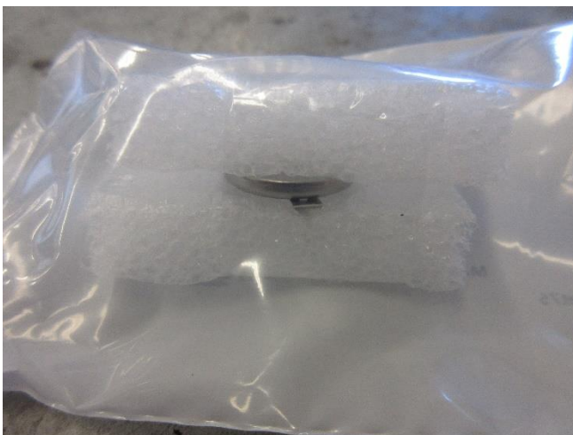
Abbildung 10: Verpackung für beschädigte Batterien kleiner 500g
