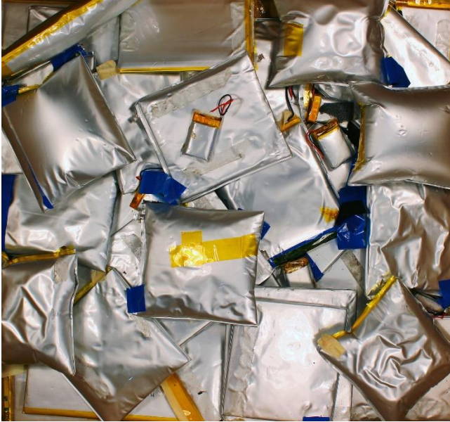
Abbildung 9: beschädigte Batterien kleiner 500g
