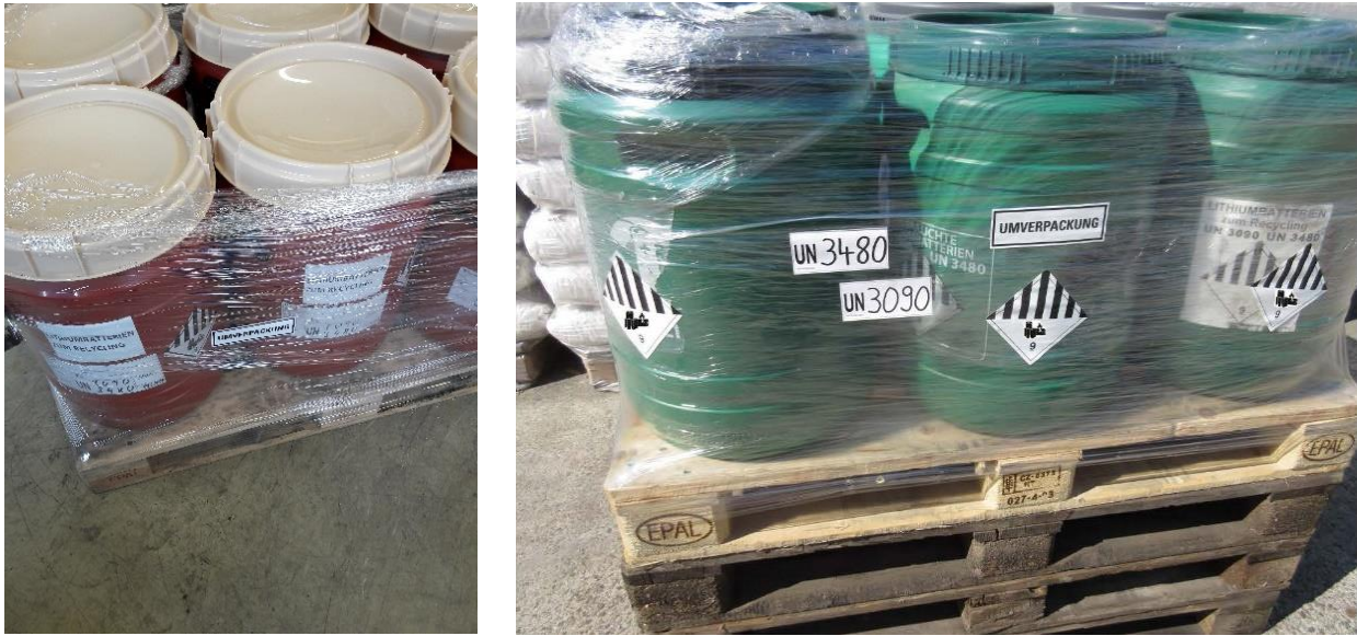
Abbildung 6: Kennzeichnung der Umverpackung
