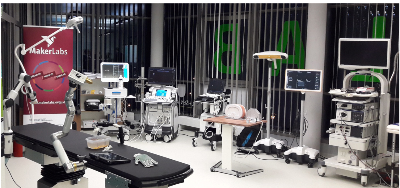
Der Simulations-OP mit verschiedenen Ultraschallsystemen, OP-Liege mit Roboterhalteam, Navigations- und Trackingsystemen sowie einem Endoskopie-Tower.
