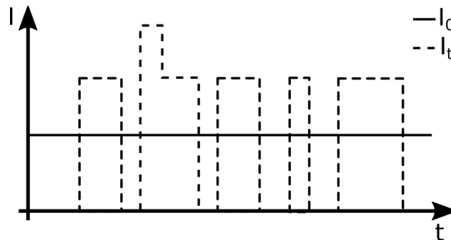
Abbildung 45: Signalverlauf Schrotrauschen (klingt wie fallende Schrotkugel)
