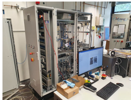
Abbildung 3.24: Teststand für die Untersuchung des URFC-Stacks
