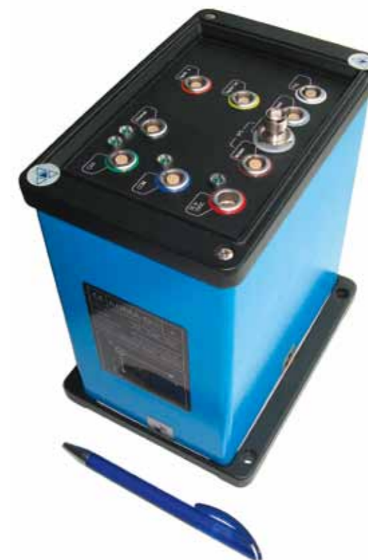
Fahrdynamikmesssystem „ADMA-Gentrylevel“: Es erfasst die Bewegung des Fahrzeugs in alle Raumrichtungen.
