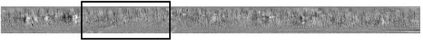
Wirbelstrom-Abbild der geprüften Oberfläche. Man erkennt deutlich die Risse.
